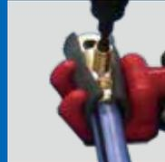
コネクタを導体に挿入し、ねじを締め込むことにより取り付けます。また、指定のトルクに達するとネジがねじ切れる構造となっているため特別なトルク管理も不要です。
