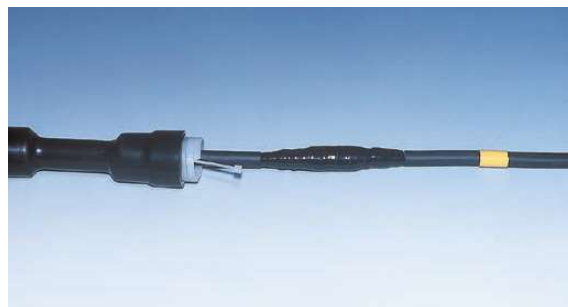
⑤付属の絶縁テープにてケーブル絶縁体上から耐火処理部分に1/2ラップで1往復巻き付け、その上をPVCテープで押さえ巻きしてください。
