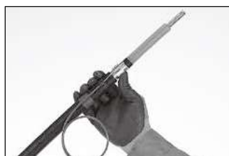
1. 接地クランプの取付け。
