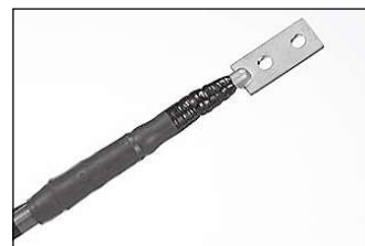
4. 端子取付け後、充電部をテープで防水処理し、完成。
